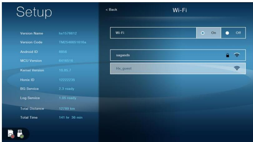
В режиме инженерного меню пункт Wi-Fi должен быть в положении ON, система автоматически обнаружит доступный Wi-Fi сигнал. Аббревиатура db – обозначает силу сигнала, чем ниже значение, тем лучше (рекомендуемое значение 50db). Выберите доступный Wi-Fi, введите пароль, нажмите «OK», подождите немного, пока выполнится соединение. При успешном подключении появится надпись «Connected», которая будет отображаться красным цветом.
