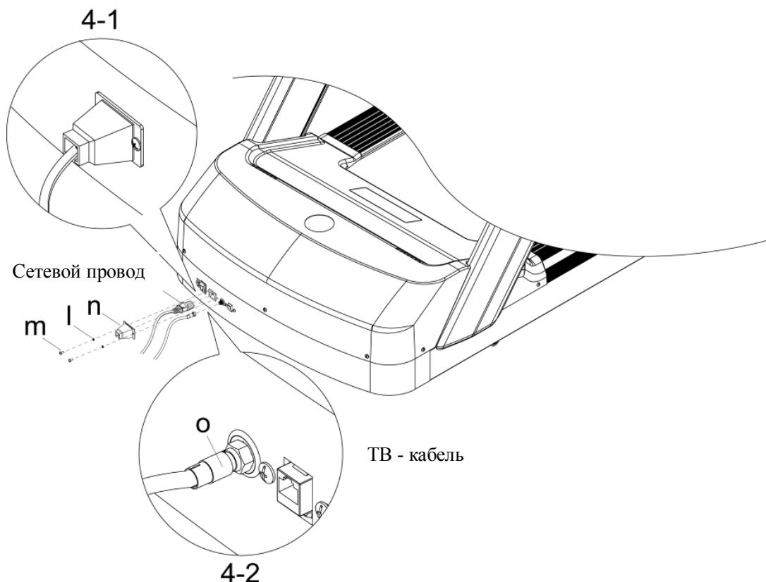
Вставьте сетевой провод в гнездо сетевого провода как указано на рисунке, затем закрепите фиксатором сетевого кабеля (n) с помощью винтов (m) и пружинных шайб (l), см. рис. 4-1.
