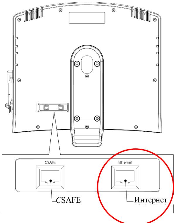
Задняя панель консоли оборудована дополнительным разъемом под интернет кабель. Рекомендуется использовать в качестве основного разъема тот который расположен под рамой беговой дорожки. Во избежание сбоя сигнала не рекомендуется использовать оба разъема одновременно.
