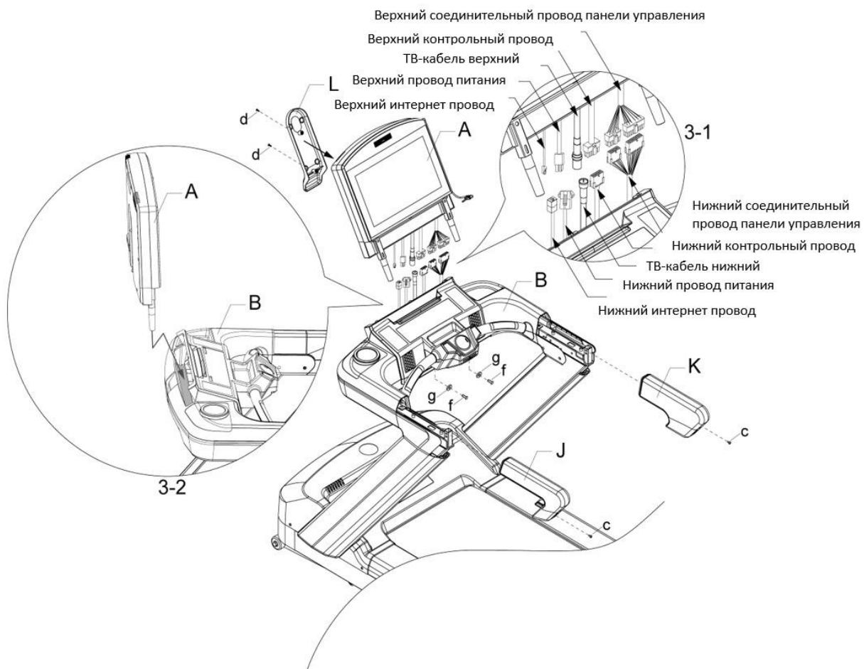
Консоль (A) устанавливается в держатель для консоли (B) согласно рисунку 3-2. Необходимо соединить все провода, выходящие из держателя (B) с проводами, выходящими из консоли, как показано на рисунке 3-1. Затем поместите соединенные провода во внутрь держателя консоли (B). Убедитесь, что ни один из проводов не пережат, зафиксируйте консоль (A) при помощи болтов (f) и пружинных шайб (g). Закрепите декоративную крышку консоли (L) с помощью
